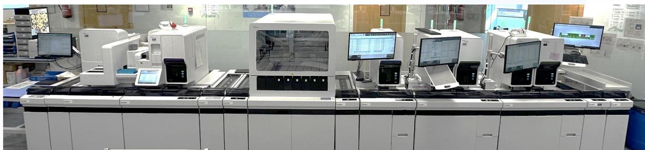
Fig. 15: Cadena Sysmex XN-9100 composta per, de dreta a esquerra, de 3 analitzadors XN-10; 2 analitzadors XN-20; un distribuïts TS; 1 extensor-tenyidor SP-50 i un Cellavision® DI-60
